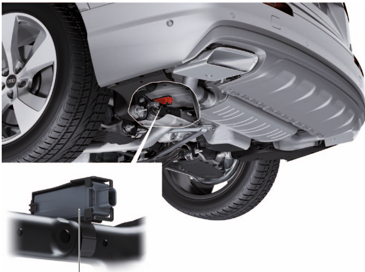
Steuergerät für Reifendruckkontrolle J502
