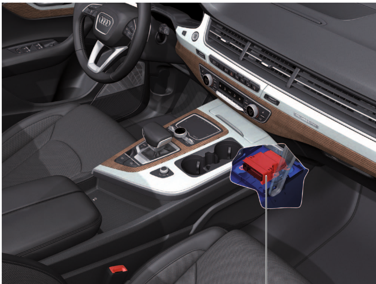
Steuergerät für Airbag J234
