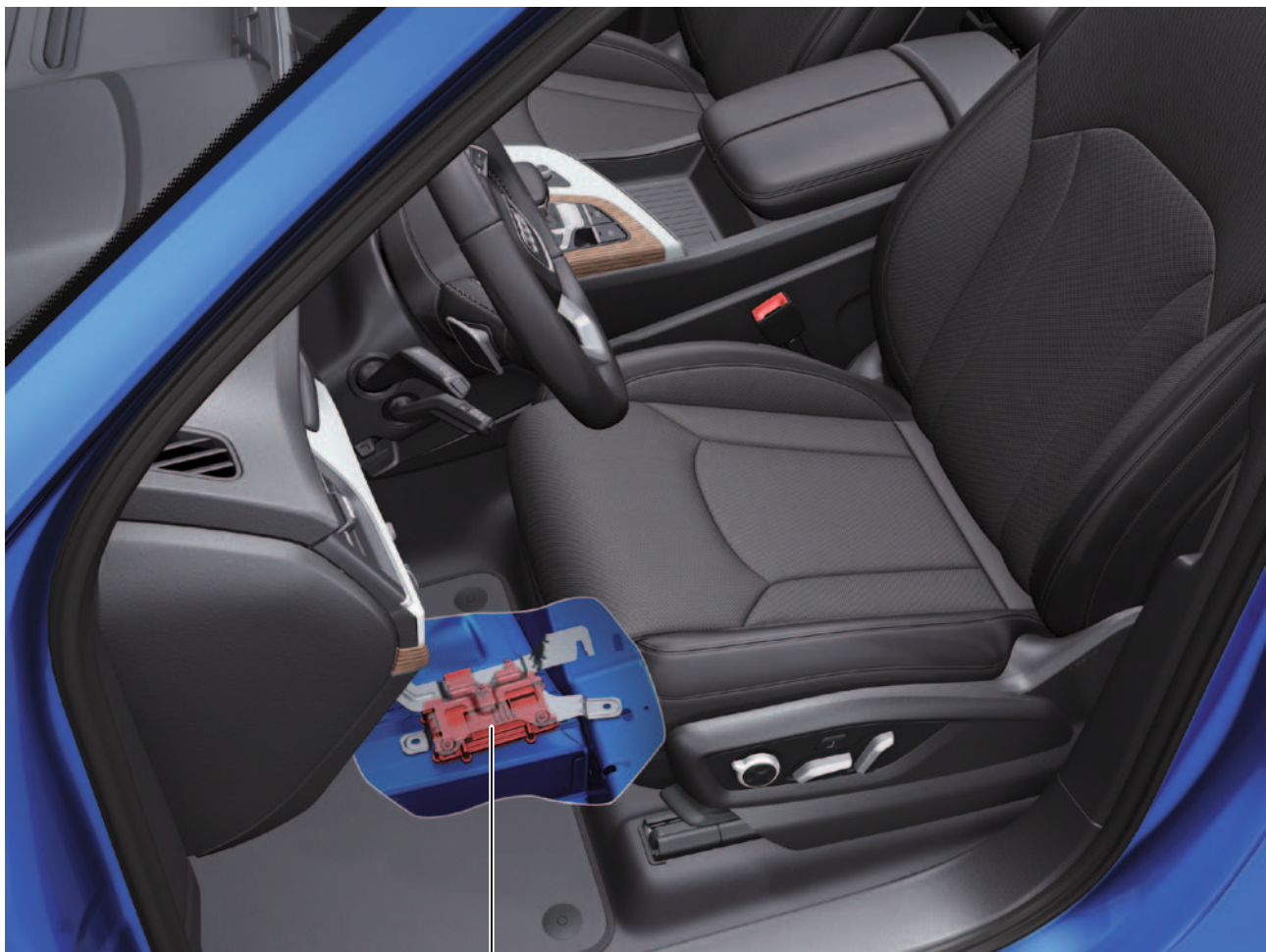
Steuergerät für Nachtsichtsystem J853
