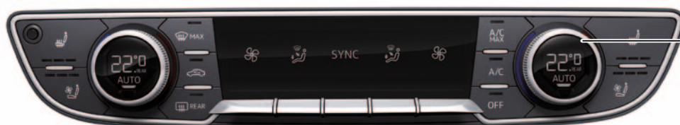
Bedienungs- und Anzeigeeinheit für Klimaanlage vorn E87
