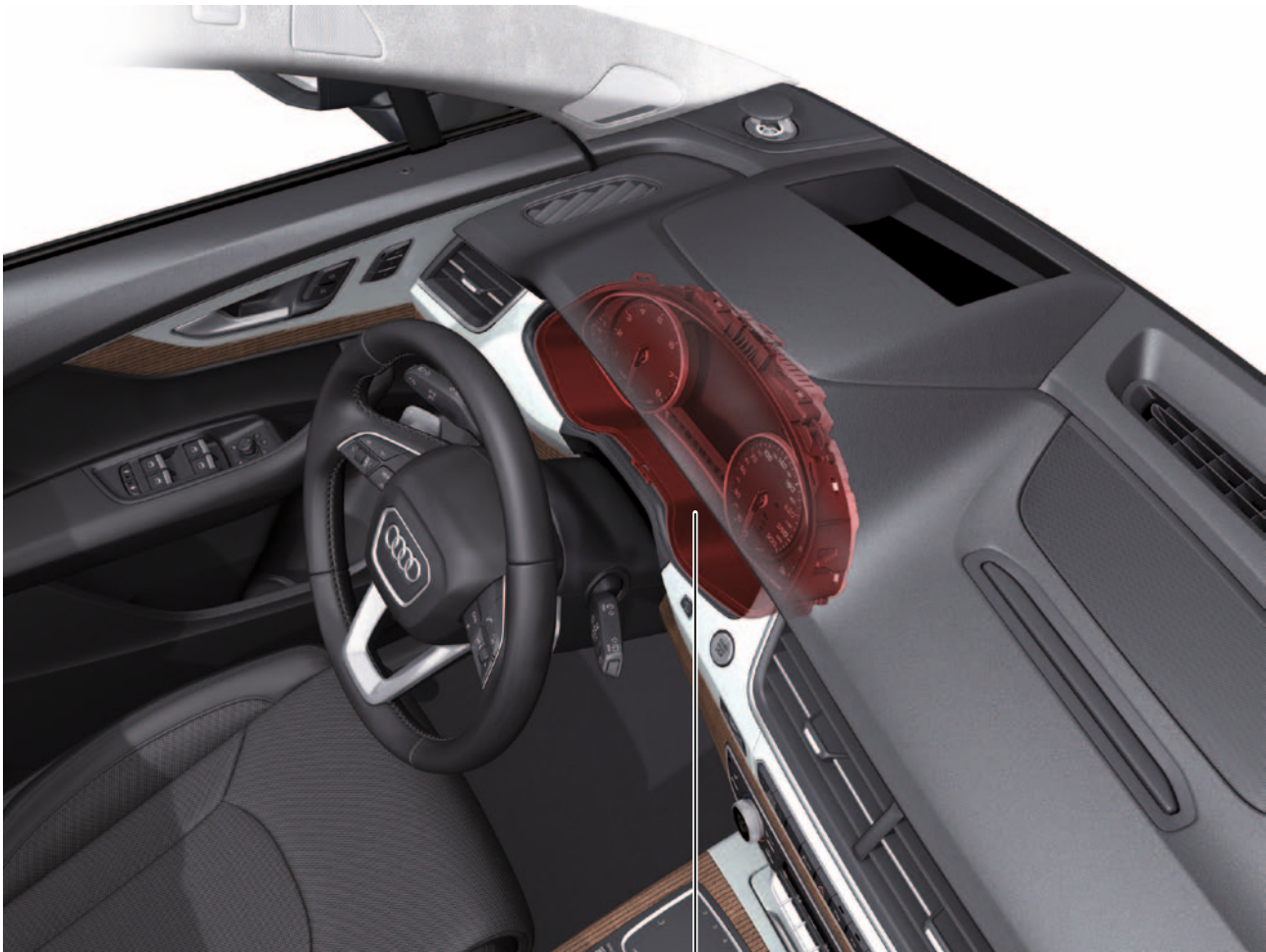
Steuergerät im Schalttafeleinsatz J285
