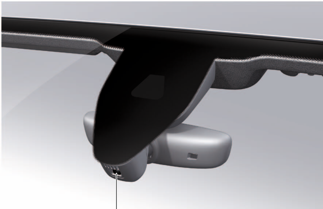
Steuergerät für Fernlichtassistent J844
