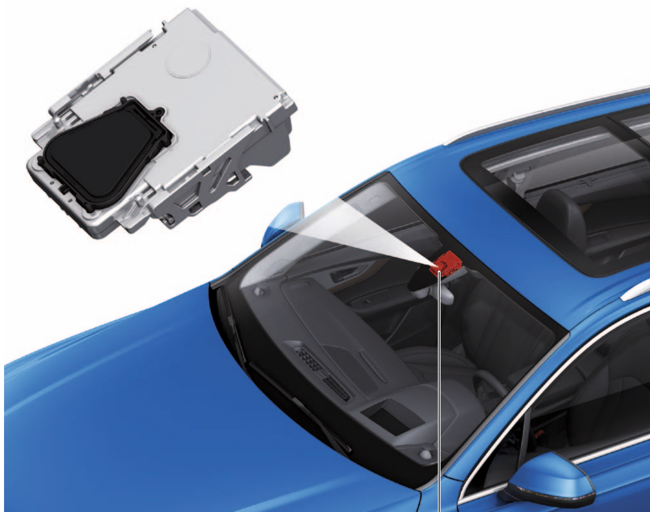
Frontkamera für Fahrerassistenzsysteme R242
