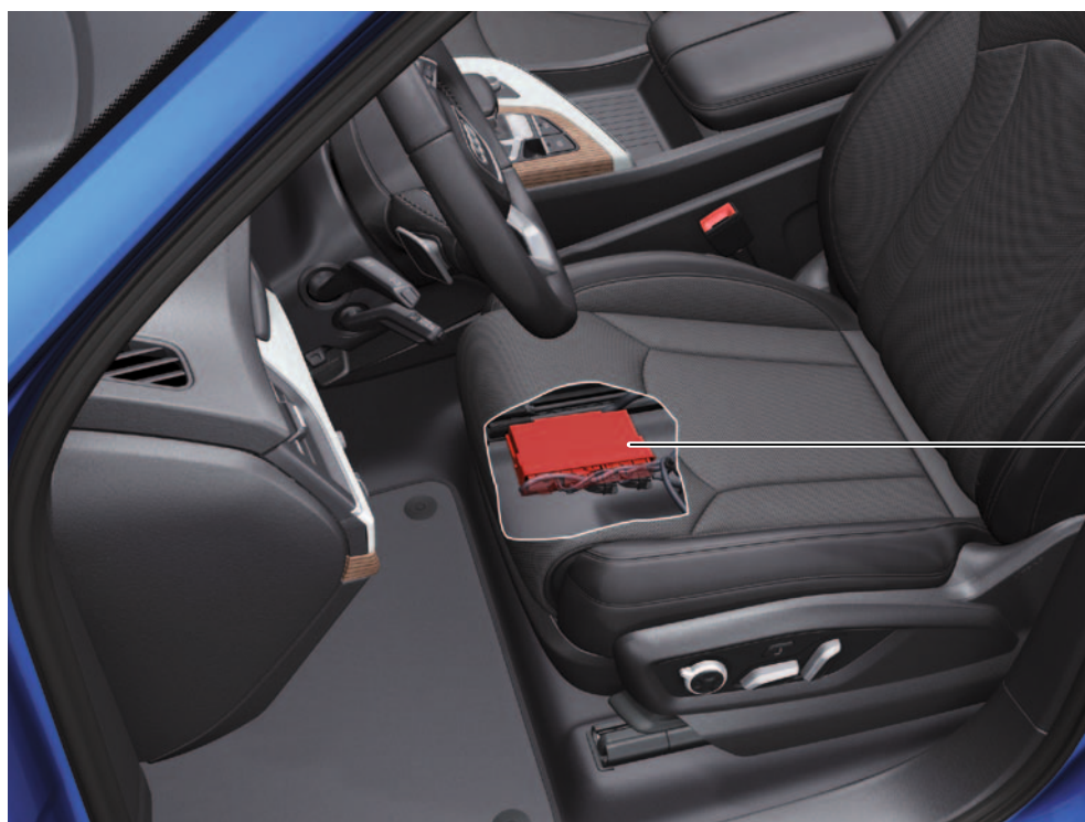
Steuergerät für Sitzverstellung und Lenksäulenverstellung mit Memoryfunktion J136
