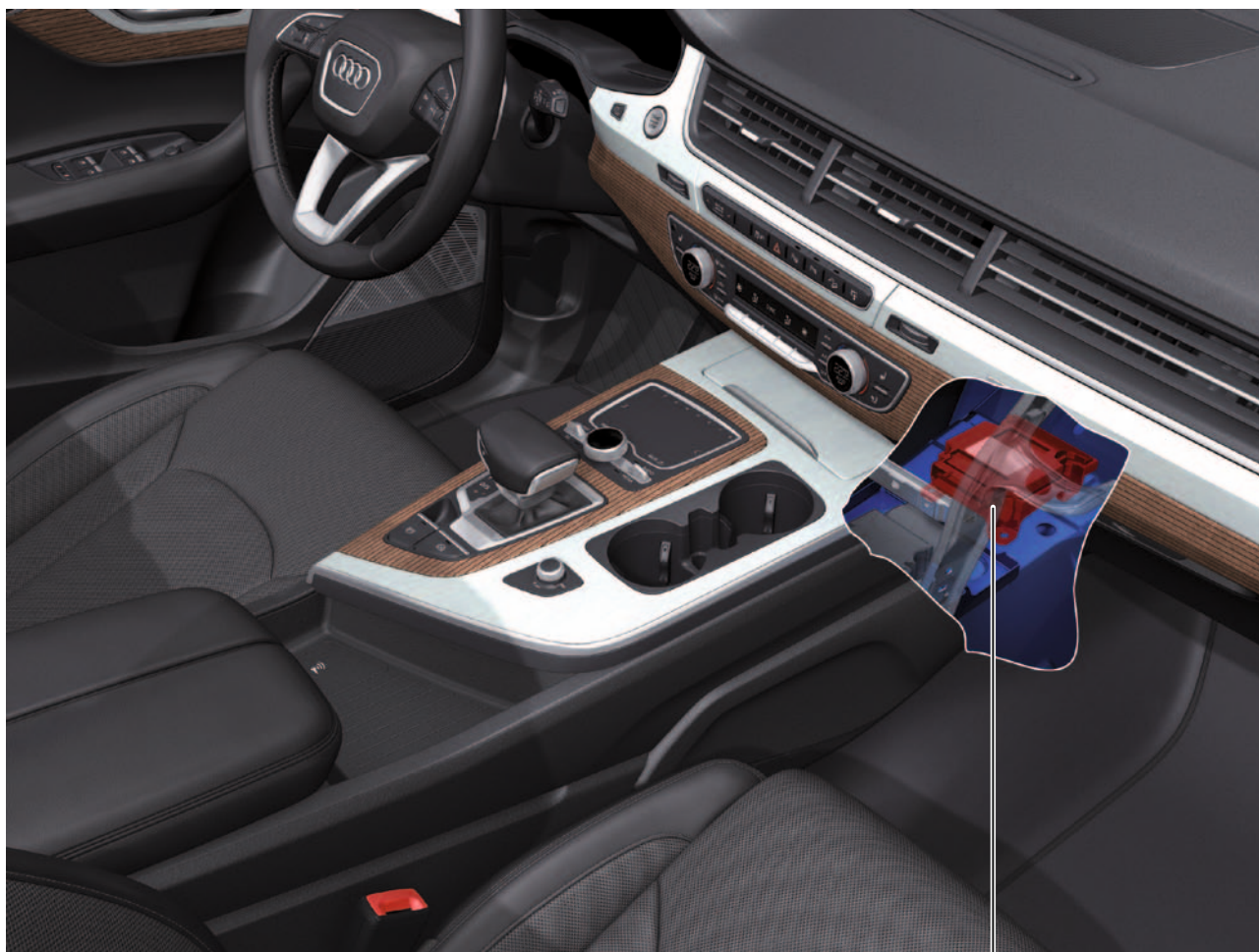
Steuergerät für Fahrwerk J775
