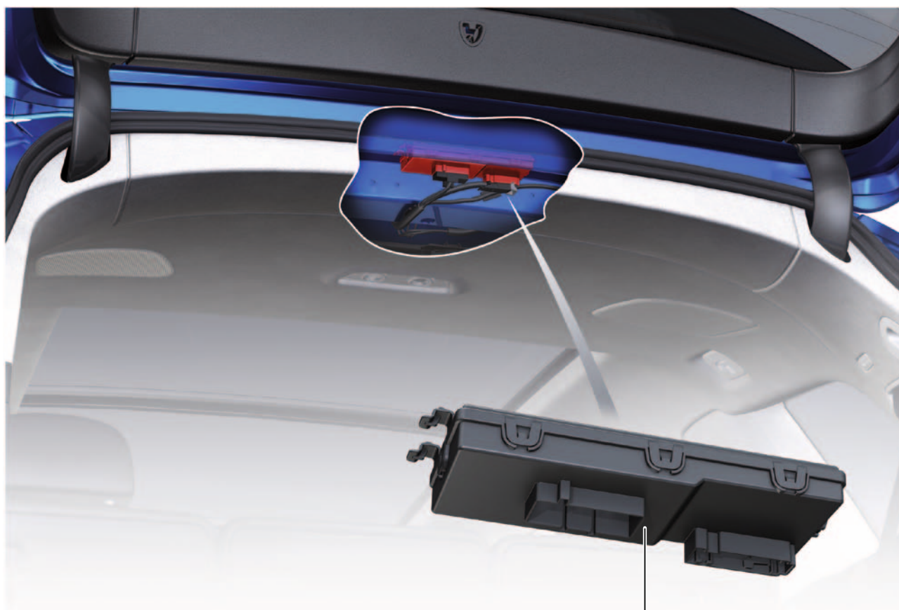
Steuergerät für Heckklappe J605
