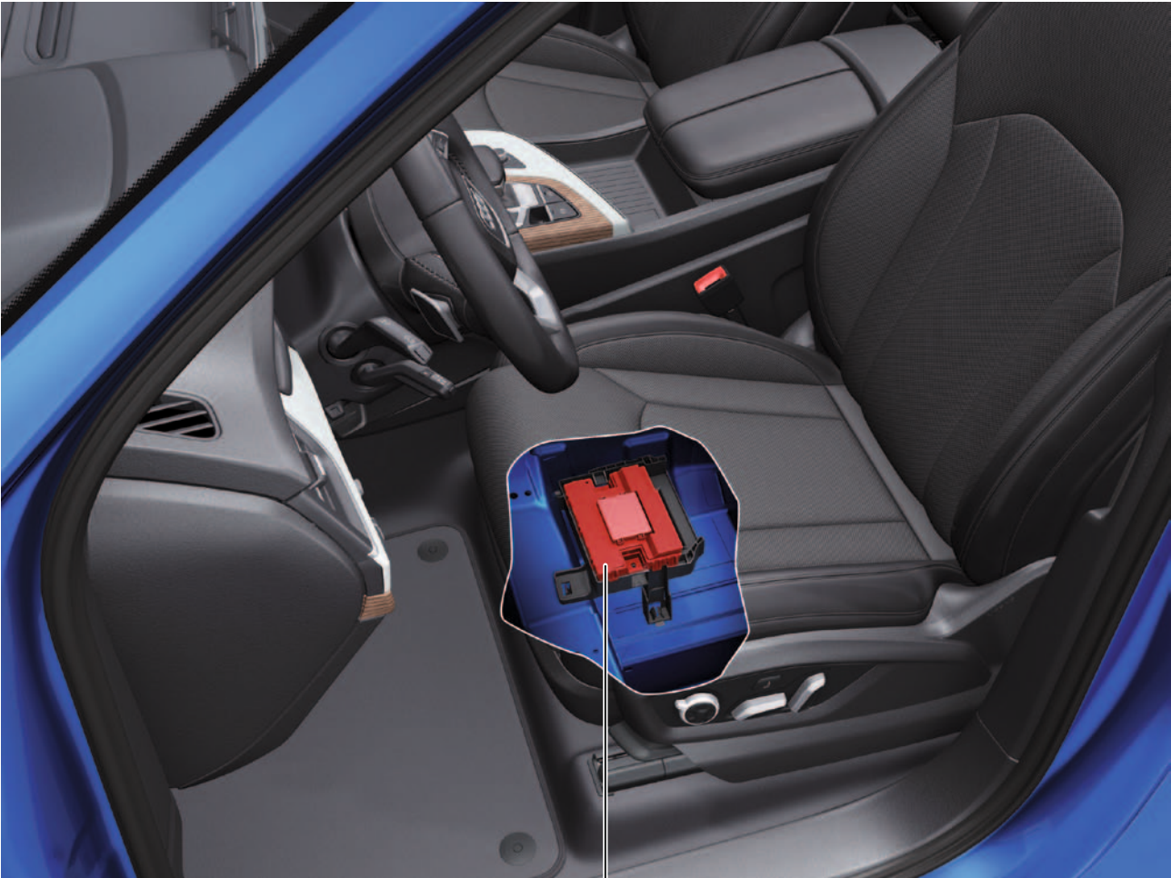
Diagnose-Interface für Datenbus J533
