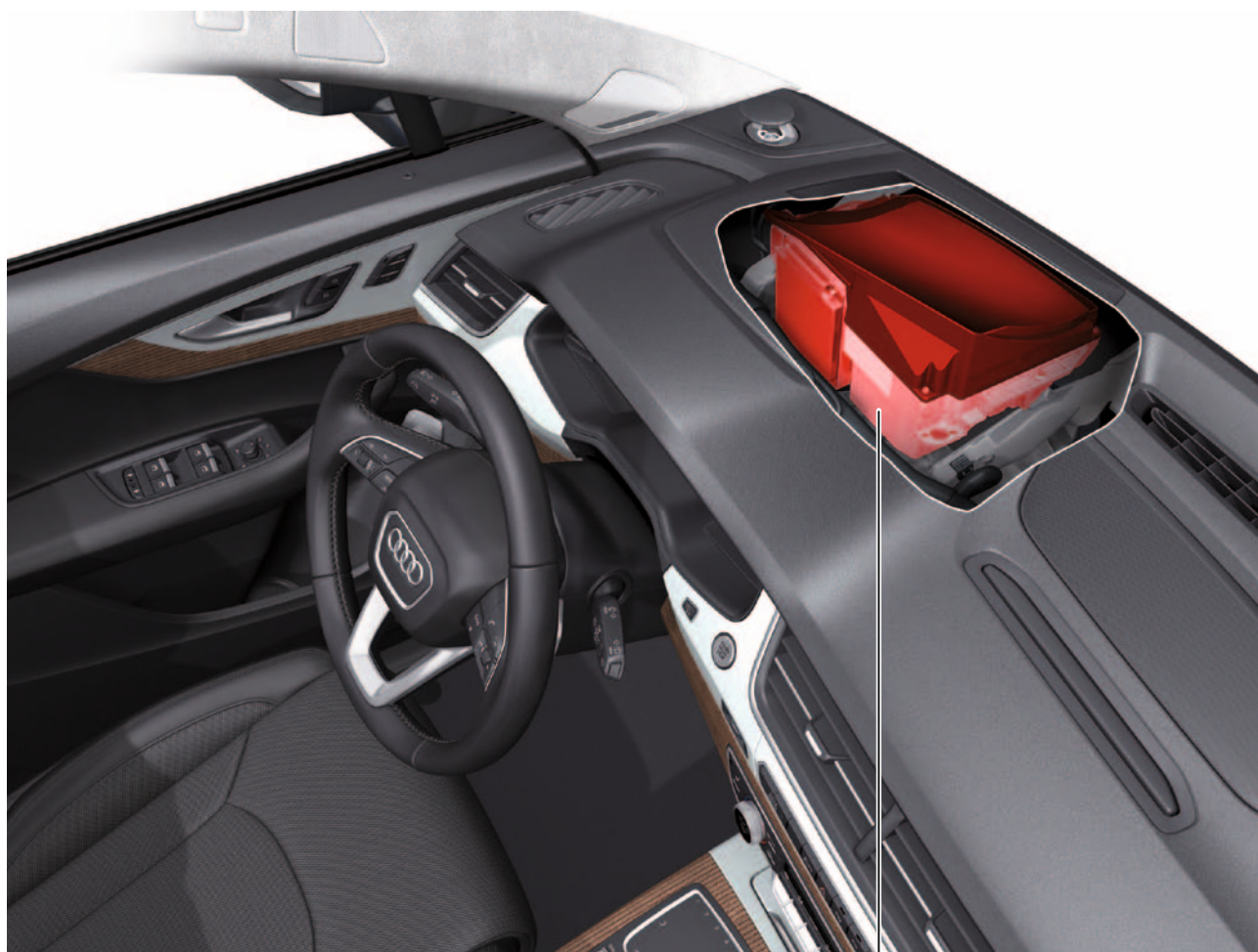
Steuergerät für Frontscheibenprojektion (Head-up-Display) J898
