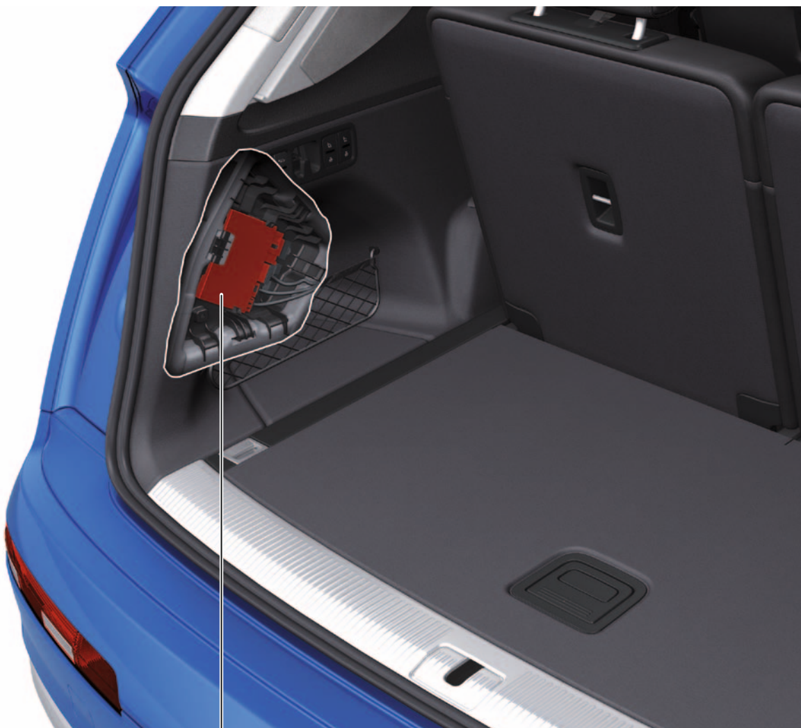
Steuergerät für Anhängerererkennung J345
