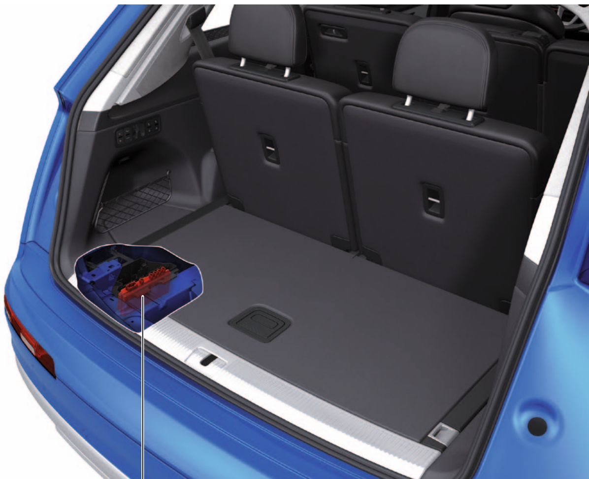
Steuergerät für Umfeld-Kamera J928
